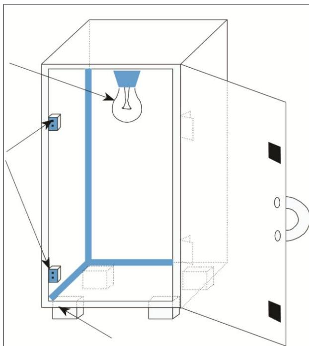
Деревянные блоки-опоры – для того, чтобы ящик не стоял на холодном полу, а также для того, чтобы его было легче поднимать
