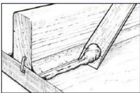
Рис.14. Удалите излишки материала за пределами кромки
